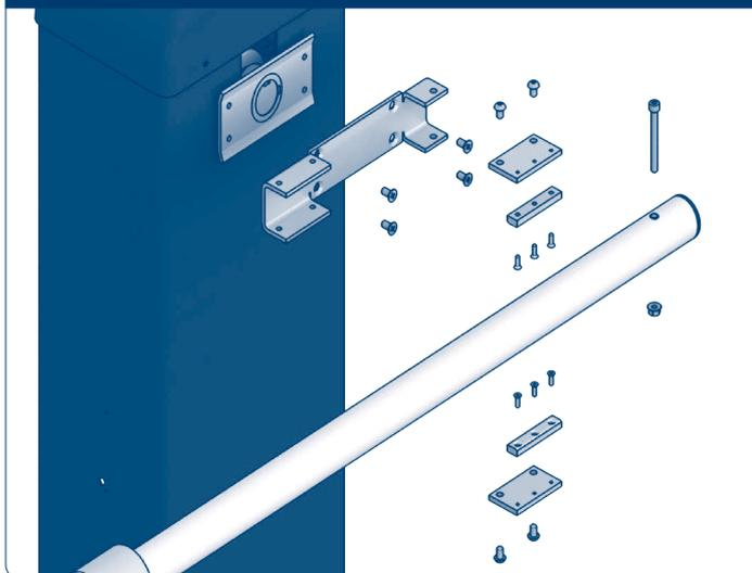
Рис. 2. Кронштейн крепления откидной стрелы, арт. DHBR-00-10
